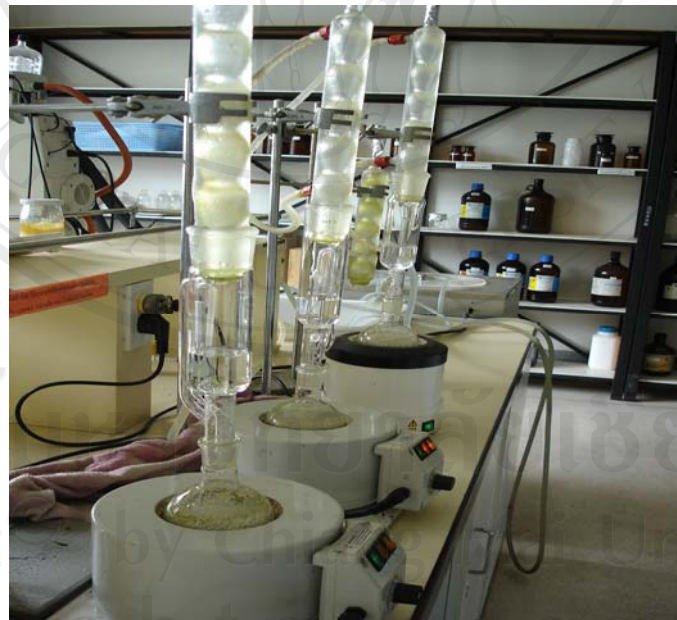
ภาพ ก-2 การสกัดด้วยวิธี Conventional method
