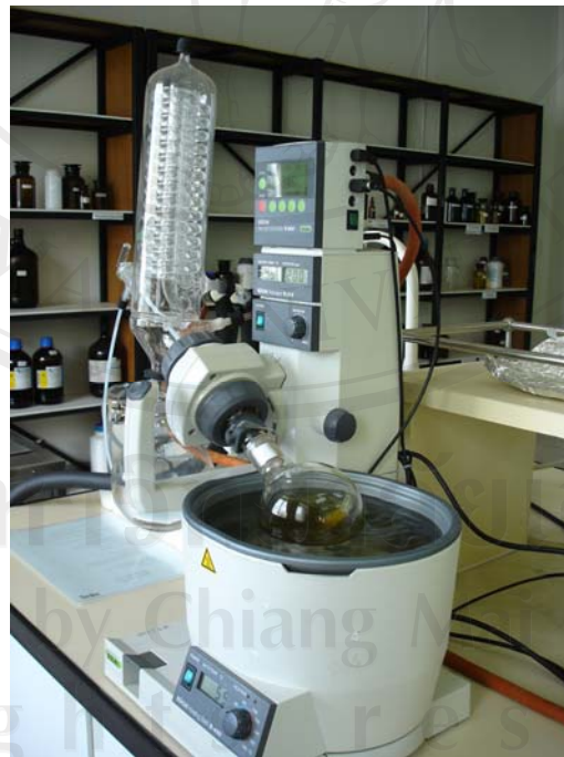
ภาพ ค-6 การระเหยบิวทานอลโดยเครื่อง Rotary evaporator
