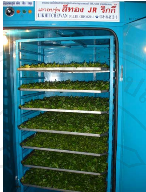
ภาพ ก-1 การอบแห้งใบเจียวกู่หลานด้วยตู้อบแบบถาดหมุน
