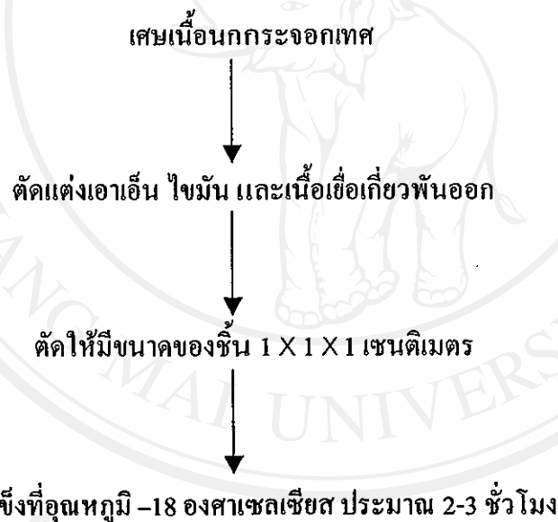
รูปที่ 3.1 ขั้นตอนการเตรียมเนื้อเพื่อผลิตเศษเนื้อนกกกระจอกเทศขึ้นรูป
