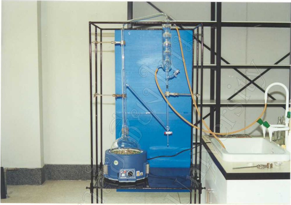
ภาพที่ ก.1 ชุดเครื่องกลั่นน้ำมันหอมระเหย
