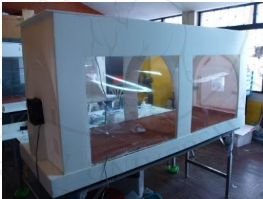
ภาพ 7 อุโมงค์จำลองทิศทางลมที่ใช้ในการทดลองในห้องปฏิบัติการ
