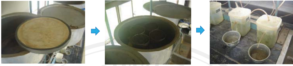
รูปที่ 3.10 การนำดินที่ทำให้อิ่มตัวด้วยน้ำใส่ใน Hanging Column ที่มีระดับแรงดึงน้ำสูง 100 เซนติเมตร เพื่อให้ น้ำที่เกินอำนาจดูดซับระบายออกจากดิน ก่อนทำการชั่งและคำนวณ เพื่อหาปริมาณความจุความชื้นในสนามของดิน
