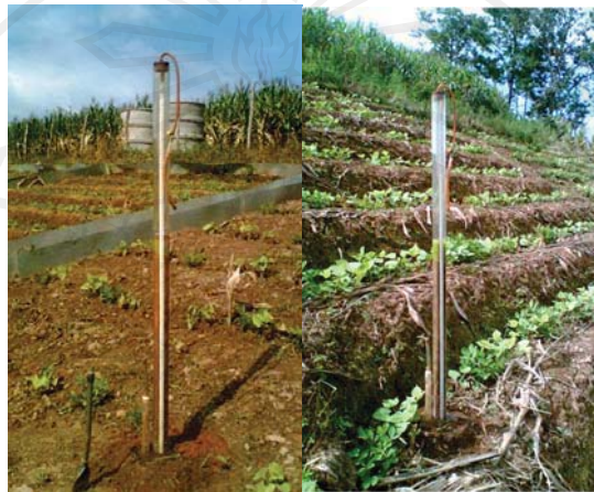
รูปที่ 3.12 การวัดการซึมน้ำเข้าสู่ผิวดิน โดยใช้เครื่องมือ Disk Permeameter วัดค่าในแต่ละแปลงย่อย
