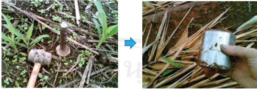
รูปที่ 3.9 การใช้กระบอกรับดิน (soil core) ขนาดเส้นผ่านศูนย์กลาง 7.5 เซนติเมตร สูง 7.5 เซนติเมตร เก็บตัวอย่างดินเพื่อนำมาวิเคราะห์หาค่าความหนาแน่นรวมของดิน
