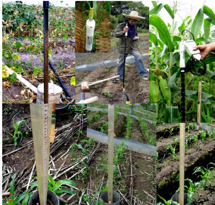
รูปที่ 3.5.2 แสดงการวัดคุณสมบัติทางอุทกวิทยาของดินบางประการ วัดความชื้นโดยใช้เครื่องมือ Time Domain Reflectometry (TDR), การวัดความชื้นโดยใช้หลอดเจาะ และการวัดการซึมน้ำเข้าสู่ผิวดินโดยใช้เครื่องมือ Disc Permeameter ในแต่ละแปลงย่อย
