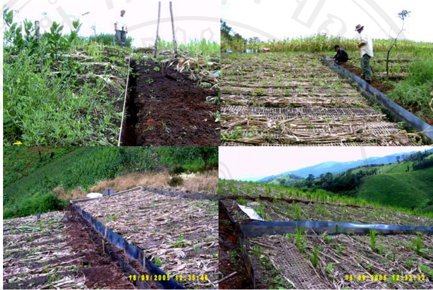
รูปที่ 3.3.3 แสดงการฝังสังกะสีรอบๆขอบแปลง เพื่อเป็นแนวกั้นขอบเขตของแปลงย่อยสำหรับวัดปริมาณน้ำที่สูญเสีย โดยการไหลบ่าบนผิวดิน (Surface Runoff) โดยใช้ถังดักตะกอนที่ติดตั้งไว้ในส่วนล่างของแต่ละแปลงย่อย
