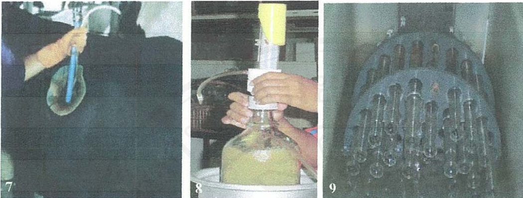
ภาพ 7 – 10 ภาพอุปกรณ์ในการประเมินค่าพลังงานของหญ้าที่แห้งโดยวิธี in vitro gas production ภาพ 7 โคที่เจาะกระเพาะรูเมน ภาพ 8 น้ำในกระเพาะรูเมนผสมกับสารเคมี ภาพ 9 หลอดตัวอย่างอาหารที่หมักปมในอ่างน้ำจุ่นที่อุณหภูมิ 39°C
