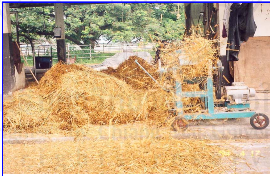
ภาพ 3.6 การหั่นฟางหมักยูเรียโดยเครื่องหั่น
