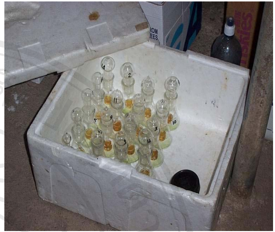
ภาพผนวก 2 การวัดแอมโมเนียไนโตรเจน ด้วยวิธี Conway method
