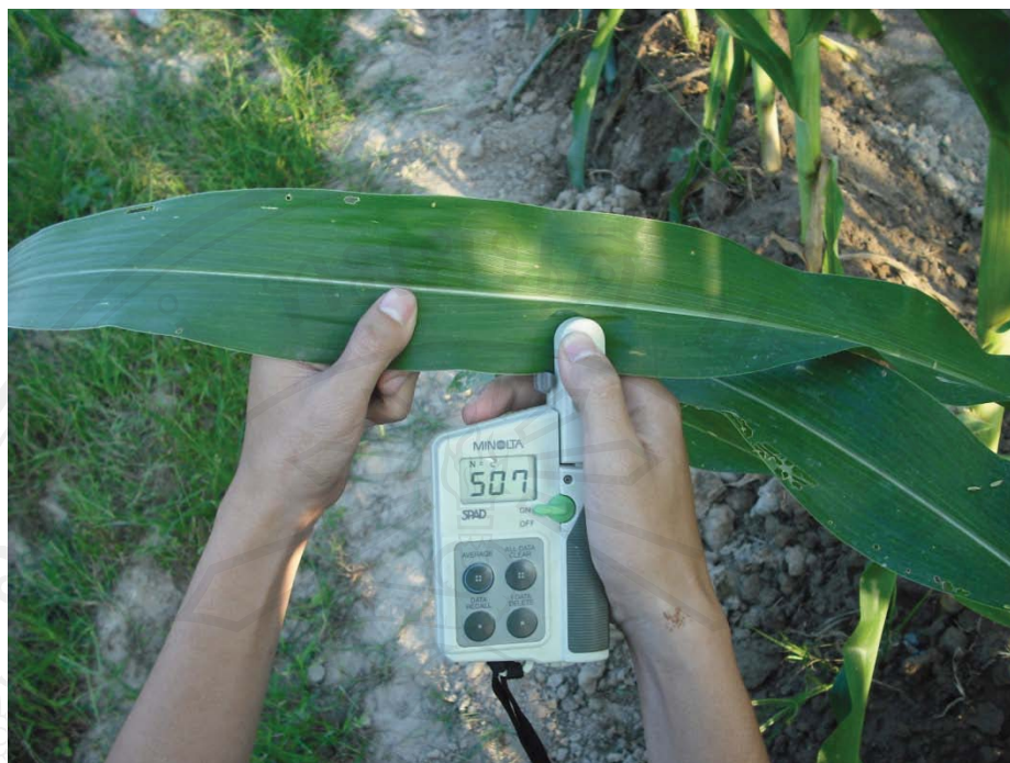
ภาพที่ 10 การวัดค่า SCMR โดยการใช้ SPAD-502
