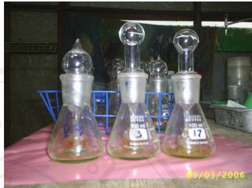
ภาพผนวก 6 การวัดแอมโมเนียไนโตรเจน ด้วยวิธี Conway method
