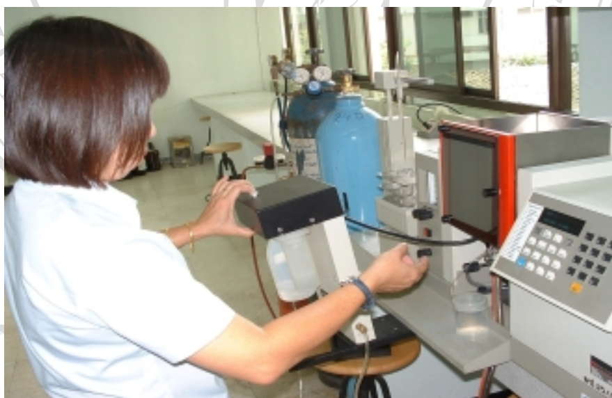
ภาพที่ 6 การวิเคราะห์หาธาตุซีลีเนียมจากเครื่อง Atomic Absorption Spectrophotometer
