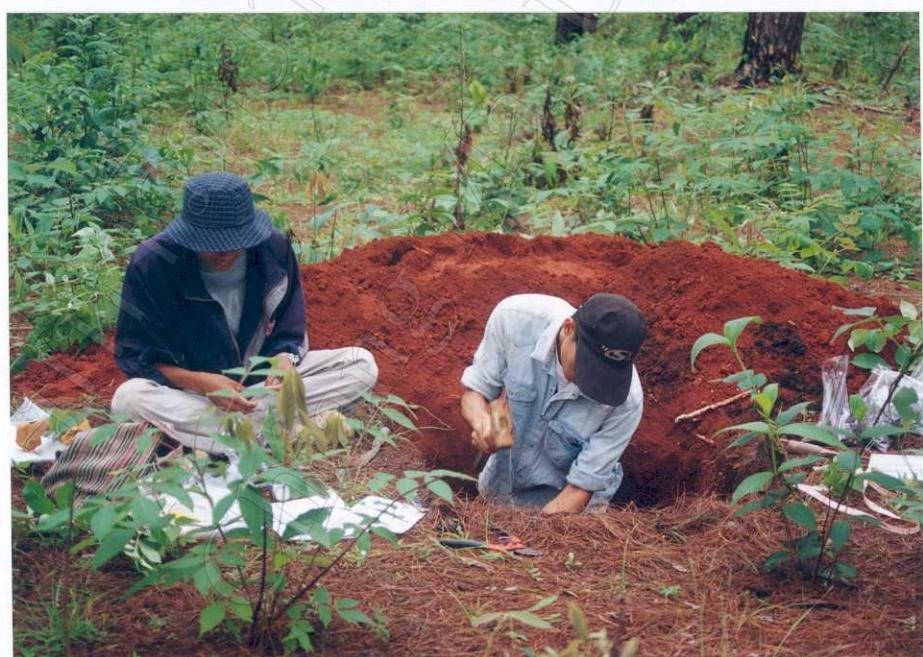
รูปที่ 4-1 การเก็บตัวอย่างดินในหลุมคินขนาด  $1 \times 1 \times 1.5$  เมตร ในพื้นที่สวนป่าดอยบ่อหลวง
