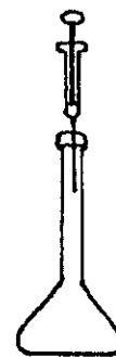
ภาพที่ 10. การเตรียมก๊าซเอทิลีนมาตรฐาน ความเข้มข้น 200 สตล
