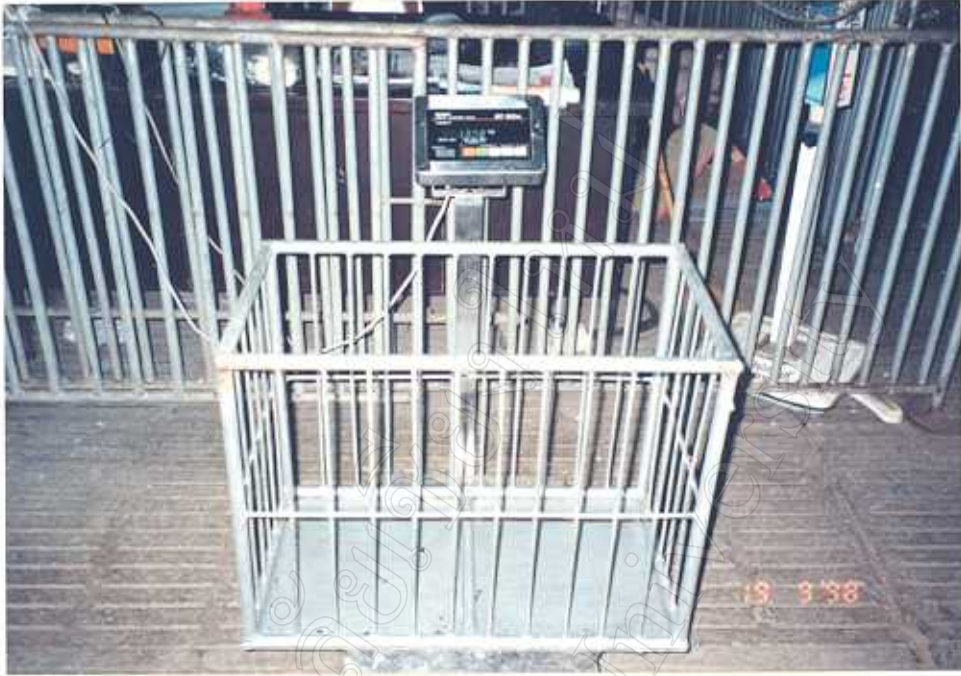
ภาพที่ 5 เครื่องชั่งสำหรับชั่งลูกสุกร เริ่มและสิ้นสุดการทดลอง
