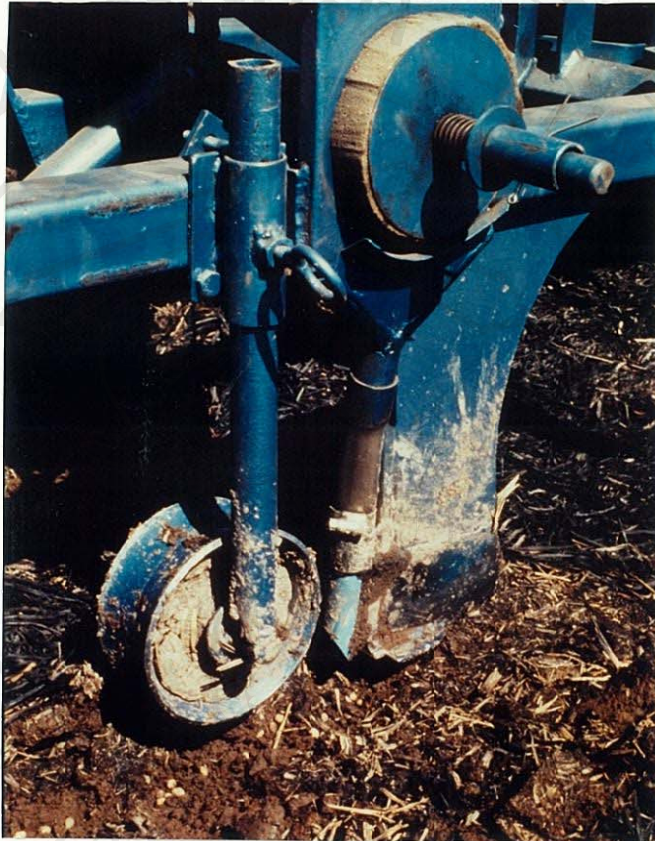
ภาพที่ 1 ลักษณะของพานเปิดดิน (soil opener) รูปตัวที่หัวกลับและลูกหยอดเมล็ดระบบพองน้ำ
