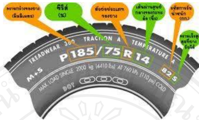
ภาพ 2.5 ตัวอย่างการอ่านตัวเลข สัญลักษณ์บนแก้มยางและเทียบค่าจากตาราง ที่มา http://www.tutorlive.tutor-thai.com/index.php?topic=898.0
