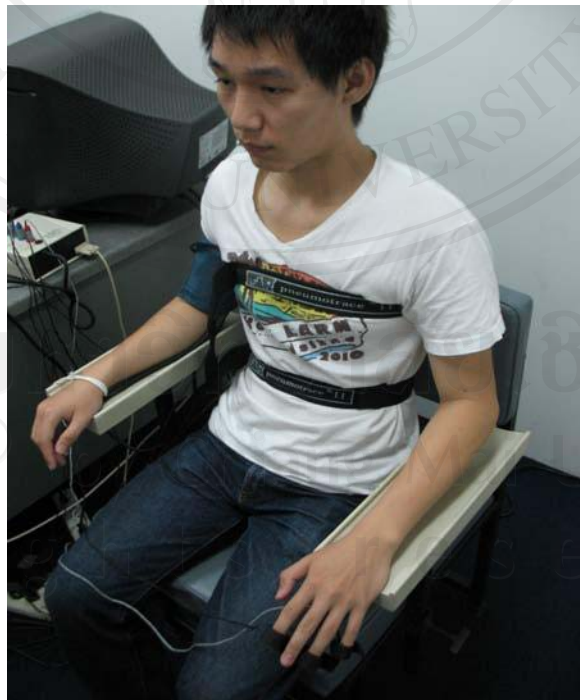
ภาพ 5.2 การเชื่อมต่ออุปกรณ์ของเครื่องจับเท็จเข้ากับอาสาสมัคร
