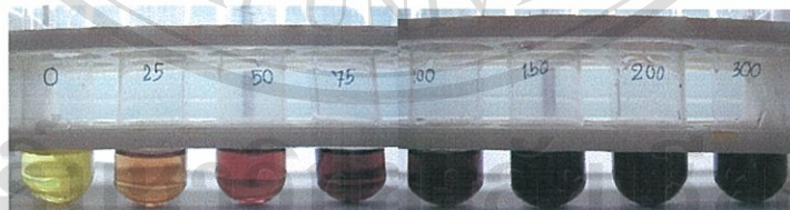
รูป 3.1 สีมาตรฐานของการทดสอบสารละลายกรดซาลิซิลิกที่ทราบความเข้มข้นแน่นอน
