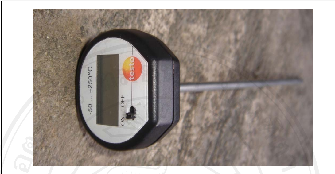
ภาพที่ 16 เครื่องวัดอุณหภูมิแบบเป็นตัวเลข ที่มา : ปวีณา ฉิมพลี ถ่ายเมื่อวันที่ 29 สิงหาคม 2553
